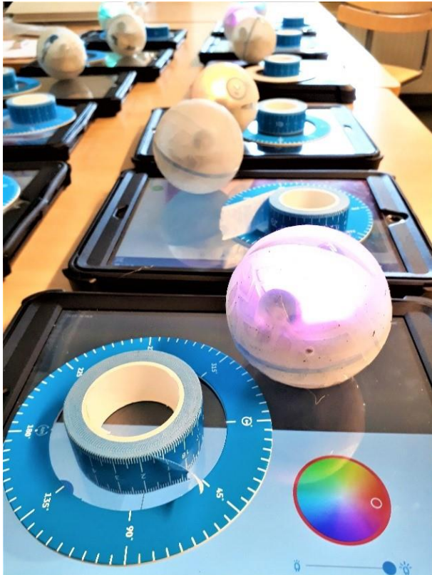
Graafiseen ohjelmointiin ja tehtäviin tarvittiin Sphero –robottipallo, tabletti, mittanauhateippi ja asteympyrä. Kuvaaja: Saana Söderlund
